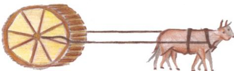
rotolamento, da coppie di buoi. In alcuni casi, i cilindri di pietra venivano racchiusi in strutture di legno provviste di ruote in ferro. Giunti nel luogo della costruzione del tempio, i blocchi venivano posizionati alle varie altezze dell'edificio con particolari **metodi di aggancio** e dispositivi ingegnosi quali **piani inclinati, verricelli, argani e carrucole**, come quelli utilizzati ancora oggi dai muratori.
